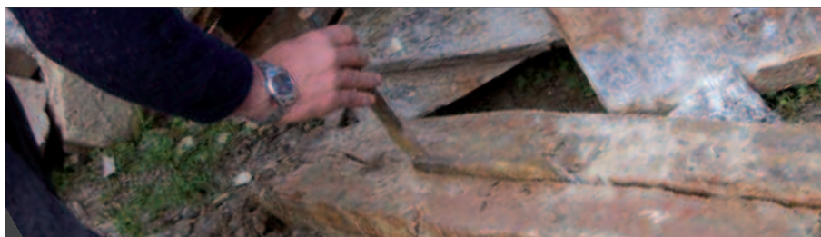
4 - Fente des blocs.
