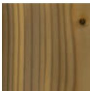
Le cèdre est une essence très estimée. Utilisé en structure, il est idéal pour la fabrication des poteaux. Il peut également être utilisé en charpente de faible portée. Enfin, il est couramment utilisé en menuiserie, agencement, revêtement et plafonds. Son odeur particulière éloigne les insectes et les vers. Ne pas confondre le Cèdre et le Western Red Cedar, originaire du Canada.
