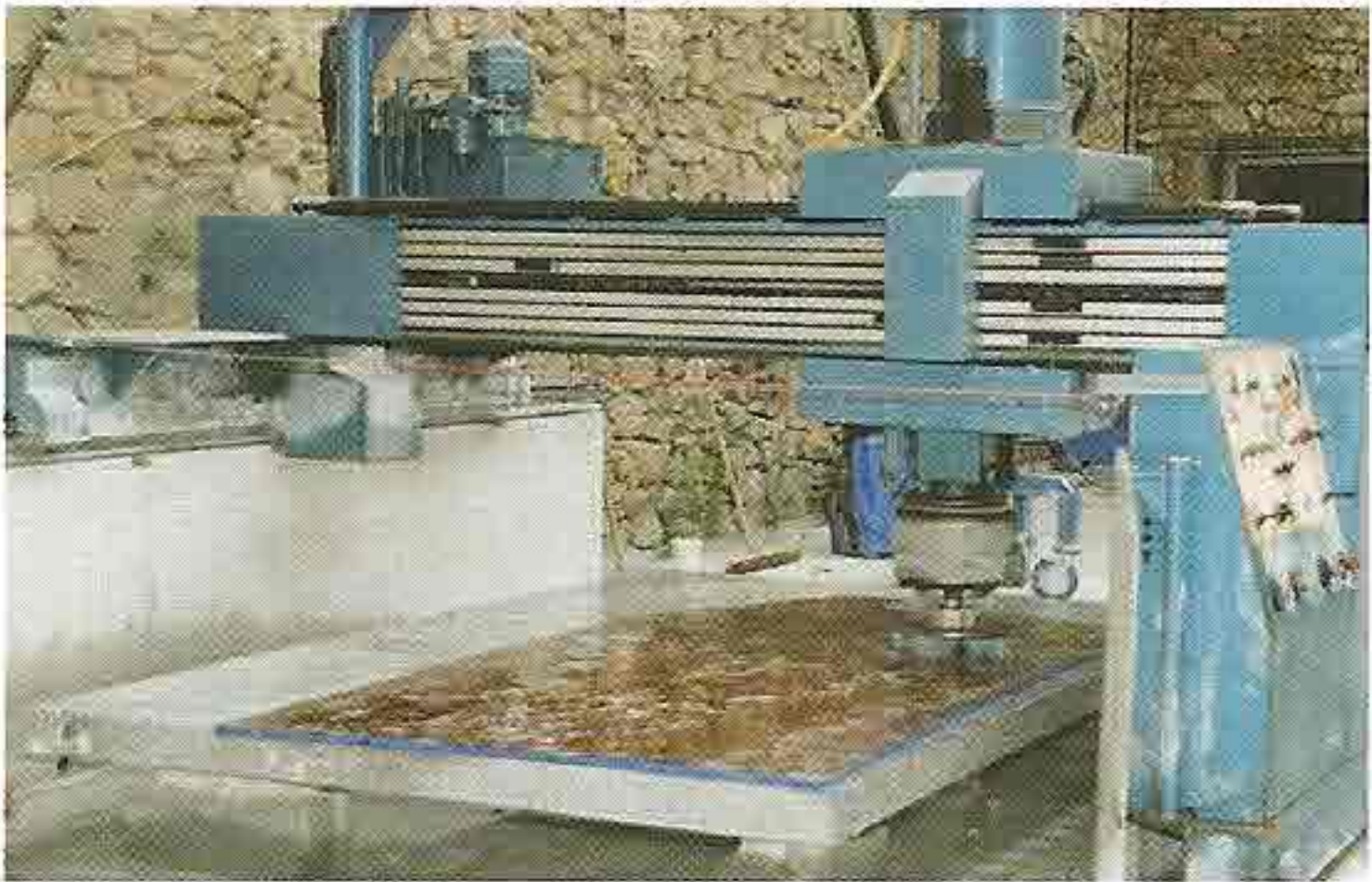
La marbrerie, opérationnelle depuis mai dernier est dotée d'un centre d'usinage numérique, d'une débiteuse numérique Bacci, d'un polissoir à plat type GB Thibaut, d'un polissoir à bande manuel Lade. A l'extérieur, l'entreprise est équipée d'un bi-fil diamanté Carl Meyer dédié à l'équarrissage des blocs avant transport ou pour réaliser des tranches épaisses.
