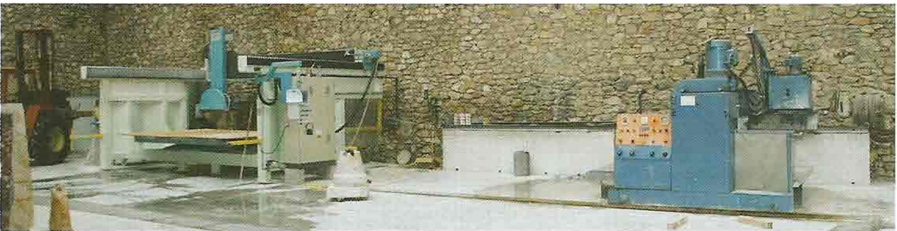
La marbrerie, opérationnelle depuis mai dernier est dotée d'un centre d'usinage numérique, d'une débiteuse numérique Bacci, d'un polissoir à plat type GB Thibaut, d'un polissoir à bande manuel Lade. A l'extérieur, l'entreprise est équipée d'un bi-fil diamanté Carl Meyer dédié à l'équarrissage des blocs avant transport ou pour réaliser des tranches épaisses.
